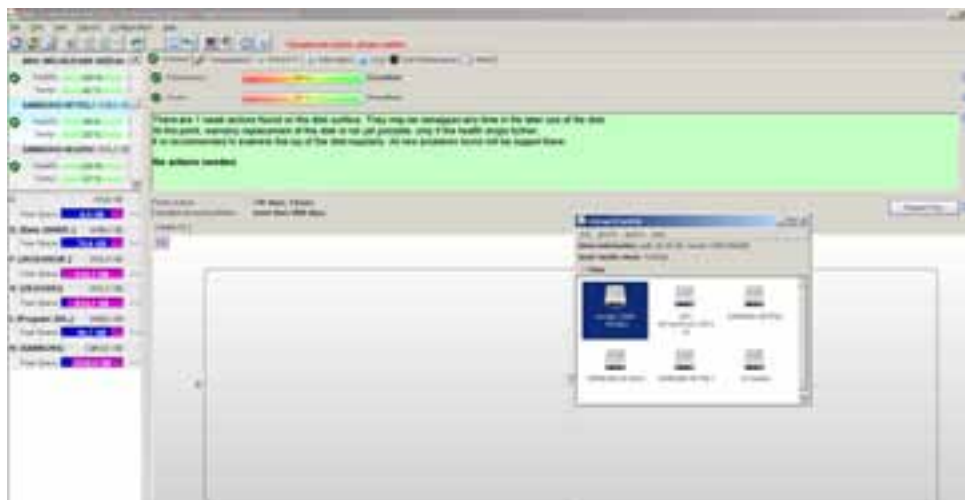
Bild 4-11. Hard Disk Sentinel kontrollerar diskarnas temperaturer men varnade också för den krånglande disken.
